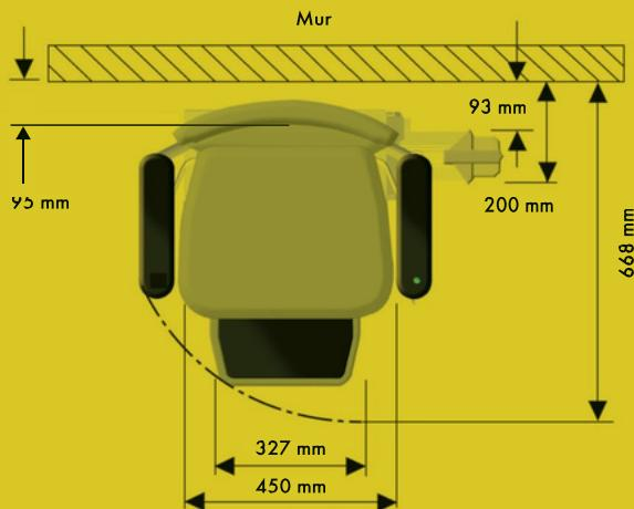
Toutes les dimensions mesurées à partir du mur sont données à titre indicatif. La présence d'une plinthe plus large ou de tout autre élément similaire peut modifier les mesures prises à partir de ce point. Les mesures sont données en millimètres.
